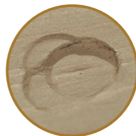
Tvrdość borovicového prkna velmi silné poškození laku a zničení vrstvy dřeva
